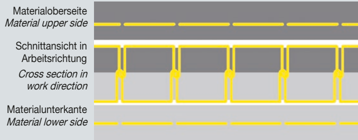
KSL 110 - Doppelsteppstich 2D-Portal-Nähanlage (mit Drehkopf) Lockstitch 2D portal sewing unit
