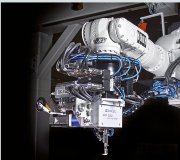
KSL RS 522 - Tufting: Z-Verstärkung Tufting: z-reinforcement
