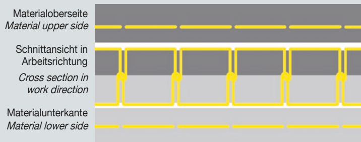
KSL 311 - Doppelsteppstich 2D-Nähanlage (mit oder ohne Drehkopf) Lockstitch 2D sewing unit (with or without rotating head)
